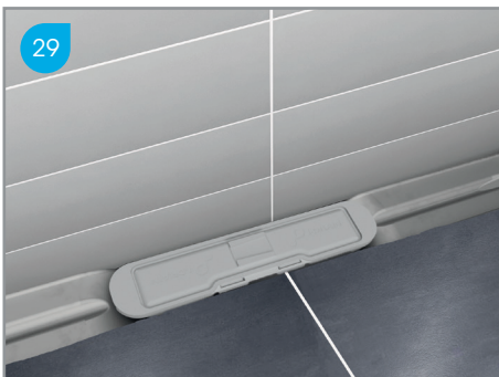
29 Tegelblok wegnemen / Remove the tile profile / Enlever le guide de pose en polystyrène / Styropor Rinnen In- nenteil rausnehmen
